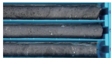
N-2孔53~56m之部分軟弱層岩心照片 軟弱層所含黏土膠結板岩碎屑完整提取
