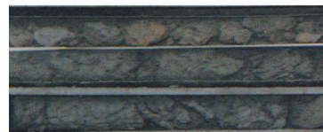
舊鑽孔BH-13, 13~16m之部分軟弱層岩心照片 所含黏土被鑽探水洗消失，僅餘破碎板岩塊
